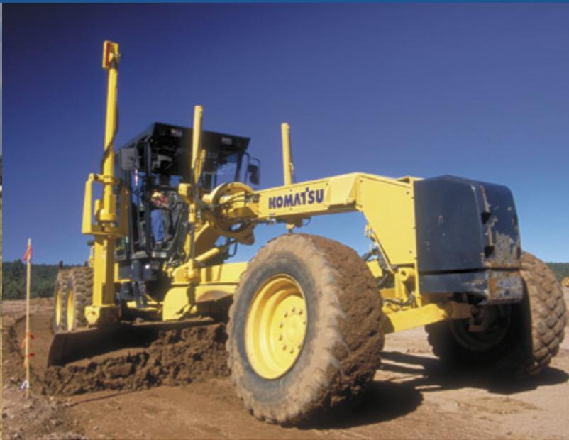
El sistema Trimble 2D de control de pendiente transversal y de elevación es un sistema que ha sido diseñado para utilizarse en motoniveladoras para tareas de nivelación fina. Usa dos sensores angulares AS400 y un sensor de rotación RS400 para calcular la pendiente transversal de uno de los lados de la hoja; además, el sistema emplea un receptor láser LR410 o un trazador de ultrasonido ST400 para proporcionar control de elevación. Al utilizar el ST400, el sistema permite el uso de líneas
