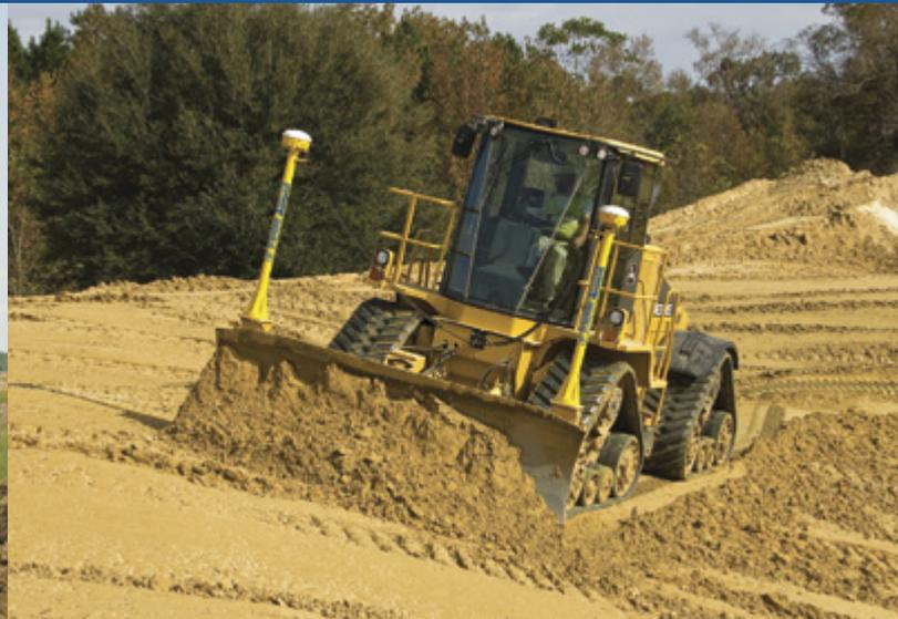
El empleo de un Trimble GCS900 Grade Control System en un bulldozer o motoniveladora permite que el operador nivele más rápidamente que nunca, incluso cuando se trata de diseños complejos.
