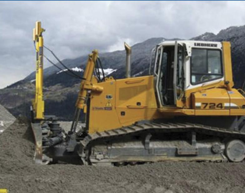
El sistema Trimble de Control de Nivelación 2D de Simple Control de Elevación es un sistema de control simple que utiliza el receptor láser LR410 para controlar la elevación de la hoja de la máquina. Resulta ideal para proyectos de construcción de menor envergadura y es una excelente inversión como primer sistema de guiado.
