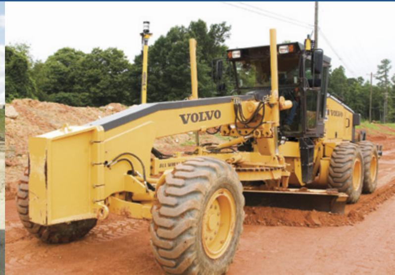
El Trimble GCS900 Grade Control System permite que el operador logre una precisión milimétrica en la capa de nivelación final con menos pasadas.
