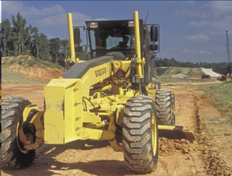
El sistema Trimble 2D para el control de Pendiente Transversal es un sistema que ha sido diseñado para utilizarse en motoniveladoras para trabajos de nivelación fina. Emplea dos sensores angulares AS400 y un sensor de rotación RS400 para calcular la pendiente transversal de la hoja. El sistema permite que el operador seleccione el lado de la hoja que va a controlarse y cambiar de lado en la pasada de retorno. Al ofrecer un alto grado de flexibilidad, el AS400
